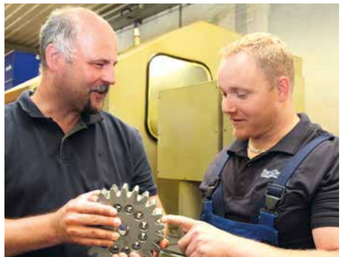
Den letzten Schliff bekommen präzise und hochgenaue Zahnräder beim Zahnflankenschleifen.
