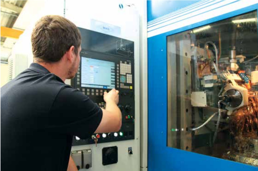
Moderne Sechs-Achs-CNC-Verzahnungstechnik ermöglicht jeden Kundenwunsch in der Verzahnungsgeometrie.
